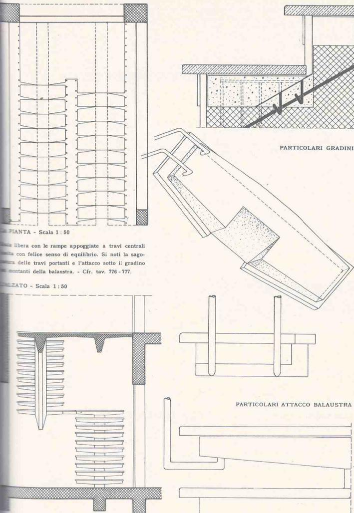
Fig. 9.21 - Scala con gradini a sbalzo sostenuti da una trave rampante centrale (Arch. Monaco e Luccichenti, da «Documenti»).
